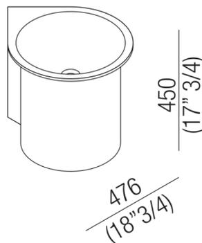
Lavabo circolare in Exmar bianco con o senza foro per rubinetto, a scarico libero. Disponibile a parete, su struttura inox a terra o nella versione a colonna, kit di fissaggio compreso. Le versioni a parete e con struttura utilizzano piletta .MET0563. Il lavabo a colonna è disponibile con scarico a parete o a pavimento.
