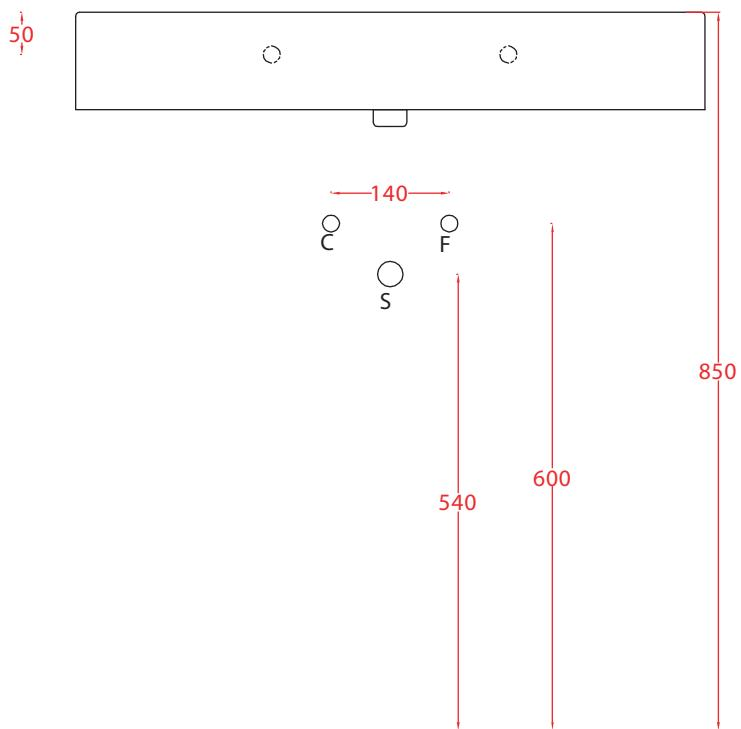
N.B. Le misure indicate possono subire una variazione dell'0,6% circa, dovuta ad usura stampi e a variazioni delle caratteristiche tecniche relative alle materie prime che compongono l'impasto .
