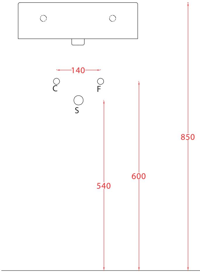
N.B. Le misure indicate possono subire una variazione dell'0,6% circa, dovuta ad usura stampi e a variazioni delle caratteristiche tecniche relative alle materie prime che compongono l'impasto.
