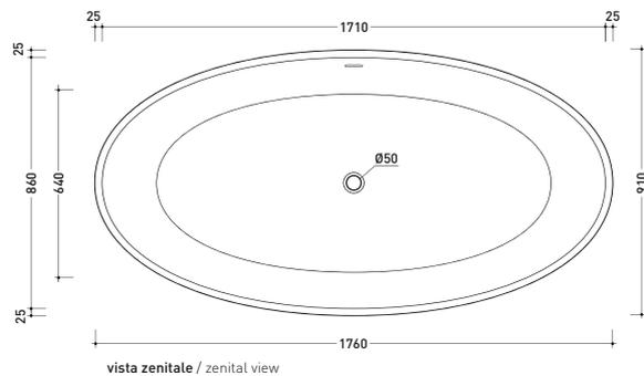
Capacità Max / Max Capacity 290 L.
